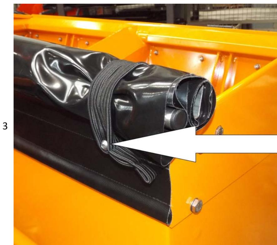
Accrocher les tendeurs en caoutchouc à la face avant (sécuriser la plaque de couverture).
