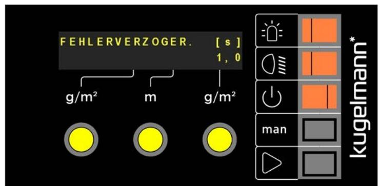
3 Régler le temps du délai d'erreur désiré au bouton tournant droit (0,0, 60,0 s).
