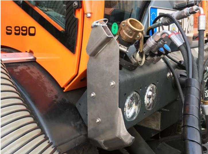
Löcher von Schlauchführung abbohren, Gewinde schneiden und montieren.
