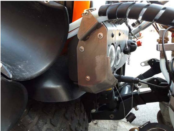
Schlauchführung montieren, Schläuche einhängen und sichern.
