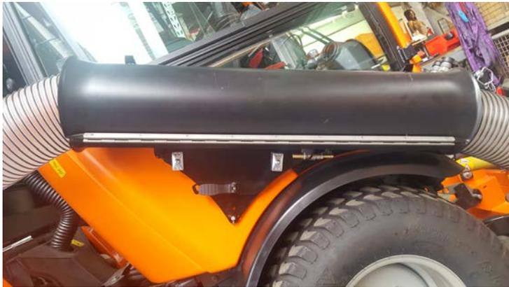
Klapprohr einhängen und mit Schnellspanner befestigen.
