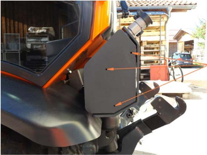
An gekennzeichnete Löchern M6er-Gewinde hinein schneiden.
