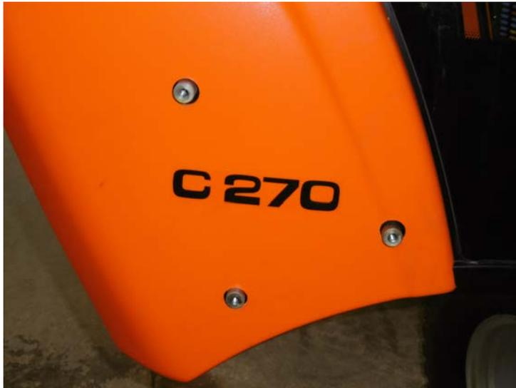
Kunststoffverkleidung aufbohren (d = 25 mm). Stehbolzen von innen festschrauben.
