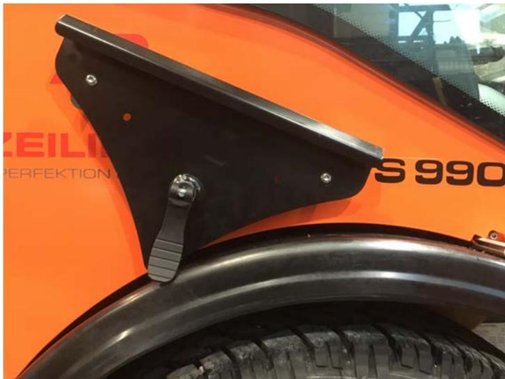
Konsole aufsetzen und festschrauben.
