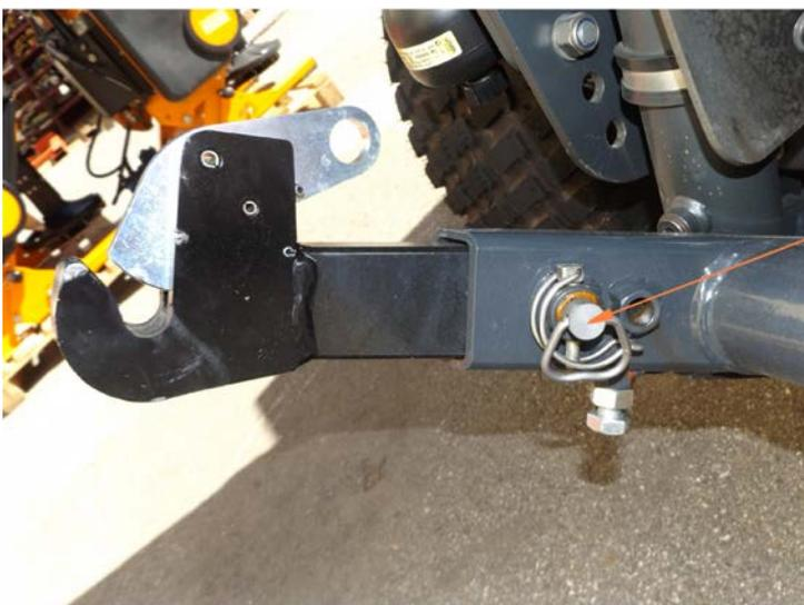
Unterlenker Kat 0 für Kehrmaschine an der Frontaushebung links und rechts einsetzen und mit Bolzen abstecken.
