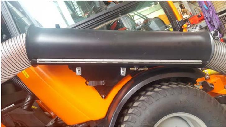
Klapprohr einhängen und mit Schnellspanner befestigen.
