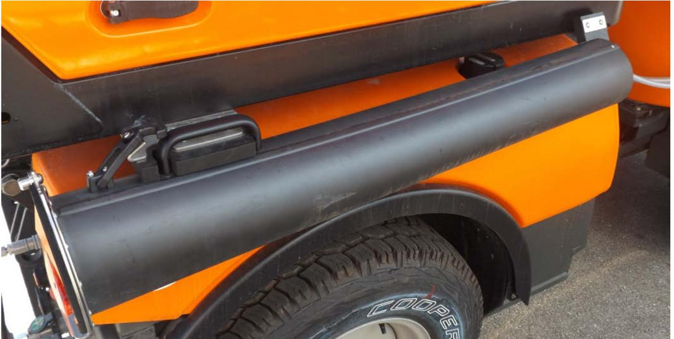
Beide Halter an vorhandenen Löchern montieren (Gewinde vorhanden):
