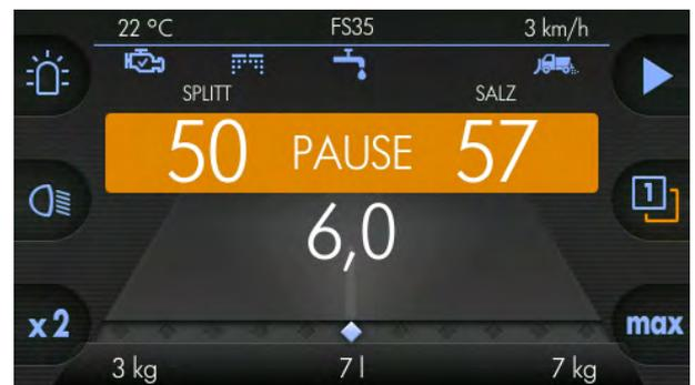
Linken Drehknopf drehen um Ausbringmenge der linken Kammer zu ändern (Bsp. 58 g/m<sup>2</sup>) →
