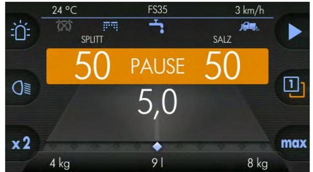
Mittleren Drehknopf drehen um die Streubreite einzustellen (4,5 m) ⇒
