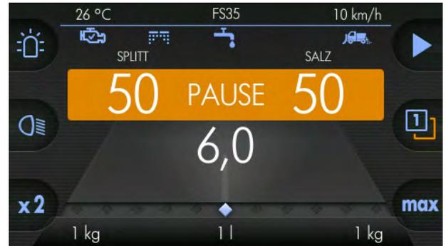
Rechten Drehknopf drehen um Ausbringmenge der rechten Kammer zu ändern (Bsp. 57 g/m<sup>2</sup>) →
