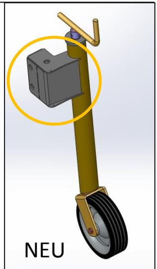
Falls der Gummilappen beim Absenken der Hochentleerung auf die Innenseite fällt und den Förderschacht verengt, ist die Aufhängung um 50mm nach vorne zu setzen.
