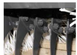
Bei einer Mähwerk-Pick-Up die Schlegel auf sichere Befestigung kontrollieren. Beschädigte Mäherschlegel austauschen. Immer gegenüberliegende Schlegel paarweise austauschen.
