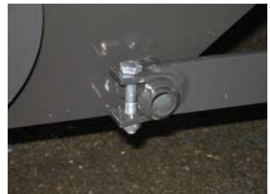
Pick-Up-Wechselstütze seitlich aufstecken. Für jede Seite gibt es eine Wechselstütze. Diese Wechselstützen verhindert ein Kippen nach hinten beim Wechseln der Pick-Up.
