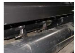
Kettenspannung kontrollieren. (großer Verschlussstopfen an jedem Kettenkastendeckel)
