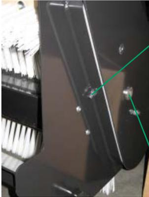
Kettenspannung an der Gewindestange nachstellen.
