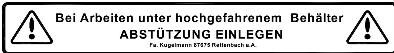
Position auf der in Fahrtrichtung gesehenen linken Seite auf der einzulegenden Stütze. Zusätzlich noch das Absperrventil am Steuerblock schließen.
