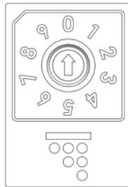
Drehregler zur Grobkorrektur drehen: (1, 2, 3, ..... 10) x 20 Imp./kg. Grundeinstellung ca. 2
