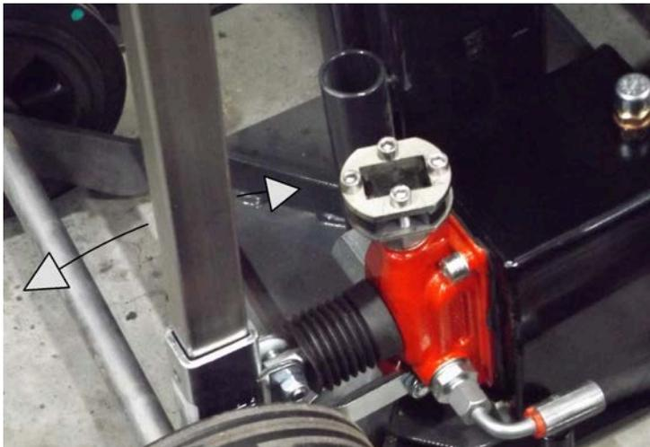
Heben des Stativs durch vor- und zurückpumpen.
