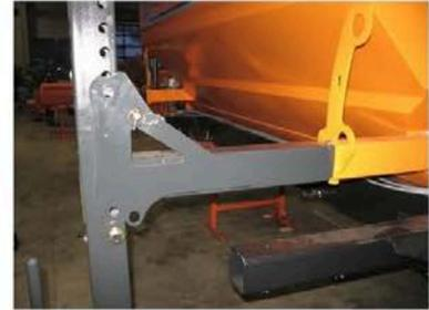
3. Stativ anheben, bis unterer Bolzen einrastet, dann oberen Bolzen abstecken und mit Splint sichern .
