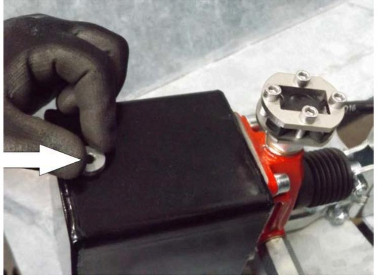
2. Mitgelieferte Entlüftungsschraube montieren:
