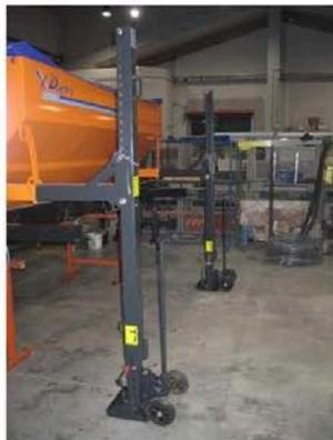
6. Bei Stützlast über 1,5 Tonnen pro Stativfuß Diagonalseile anbringen.
