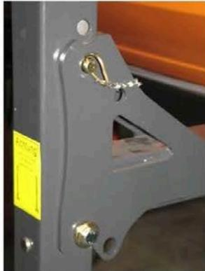
4. Sicherungsriegel nach unten klappen
