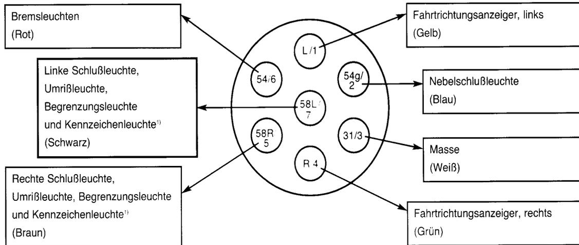
¹¹ Die Kennzeichenbeleuchtung muß so angeschlossen werden, daß keine Lampe dieser Beleuchtung mit beiden Kontakten 5 und 7 verbunden ist.
