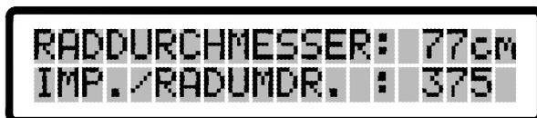
Zum Errechnen der Fahrgeschwindigkeit benötigt die Steuerung die Anzahl der gemessenen Impulse pro Radumdrehung, sowie den Raddurchmesser.
