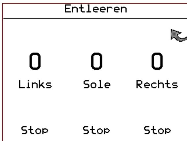
Die Geschwindigkeit mit der die einzelnen Kammern entleert werden, wird mit den darunterliegenden Drehknöpfen eingestellt.
