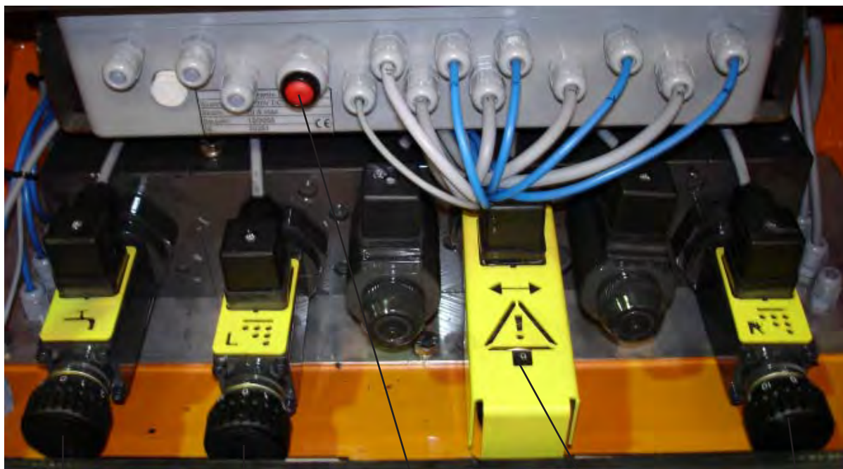
Handrad Solepumpe Handrad linke Förderschnecke Reversiertaste für Förderschnecken Handrad für Streustellenotbetrieb Handrad für rechte Förderschnecken
