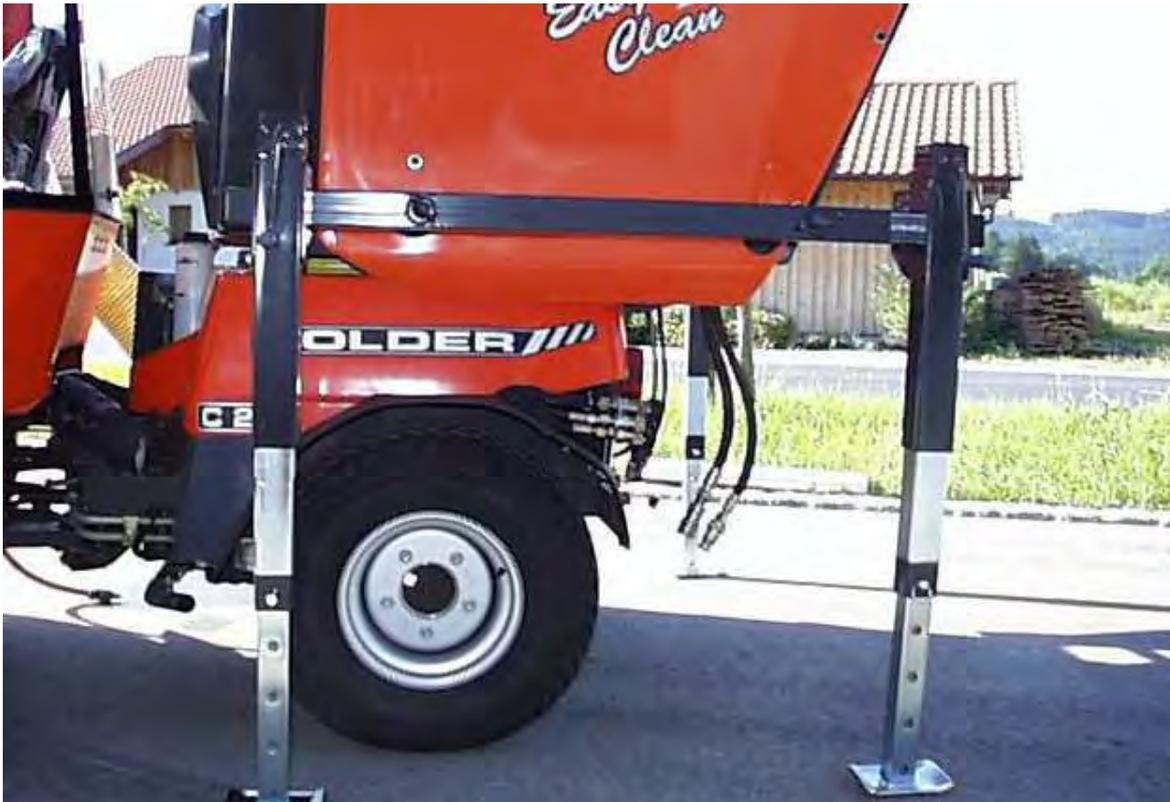
Mit den Kurbeln den Behälter nun soweit absenken bis sich die zwei Bolzen am Kipprahmen hinten, unten, stecken und sichern lassen. Die Kurbeln des Stativs können nun zurückgedreht werden, das Stativ wird zerlegt. Splinte von den Sicherungsrohren nehmen, Rohre herausziehen und die beiden Grundrahmenteile zur Seite legen.
