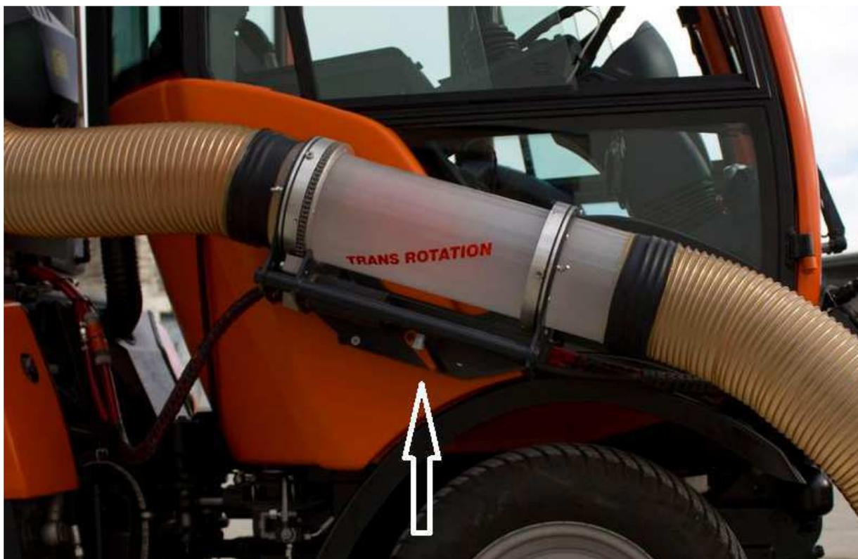
Die Saugschlauchlängen müssen bei Erstanbau und nach Einfahrzeit (wegen Schlauchlängung) angepasst werden. Bei maximalen Linkseinschlag des Trägerfahrzeuges die hintere Schlauchlänge abstimmen > geringe Streckung des Schlauches. Der vordere Saugschlauch ebenfalls mit geringer Streckung bei abgesenkter Beseneinheit ablängen.
